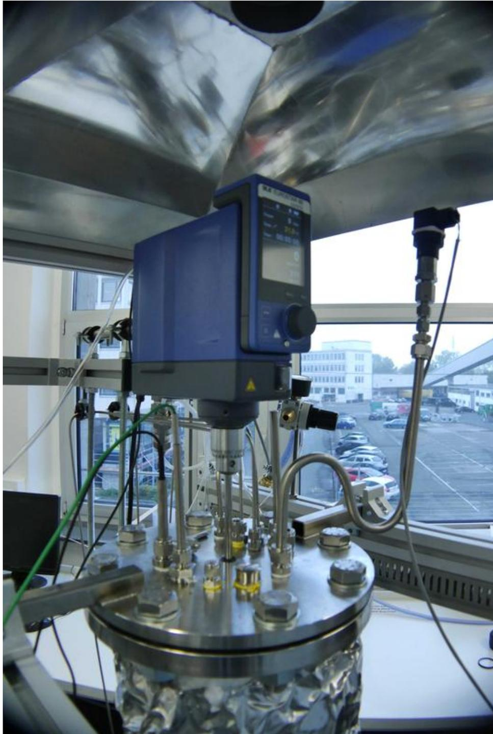
Aufnahme des druckaufgeladenen Laborfermenters an der FAU
