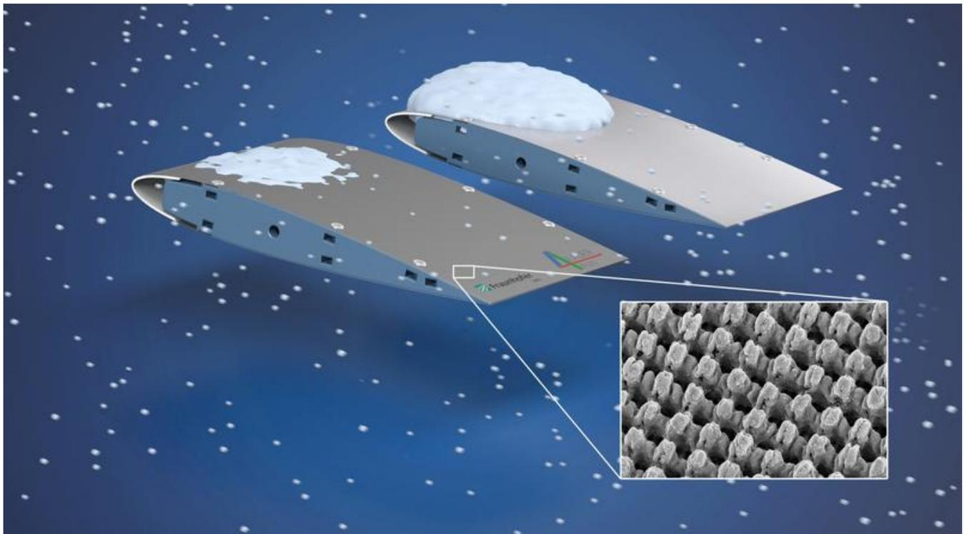
Eisschutz durch Laserstrukturierung
