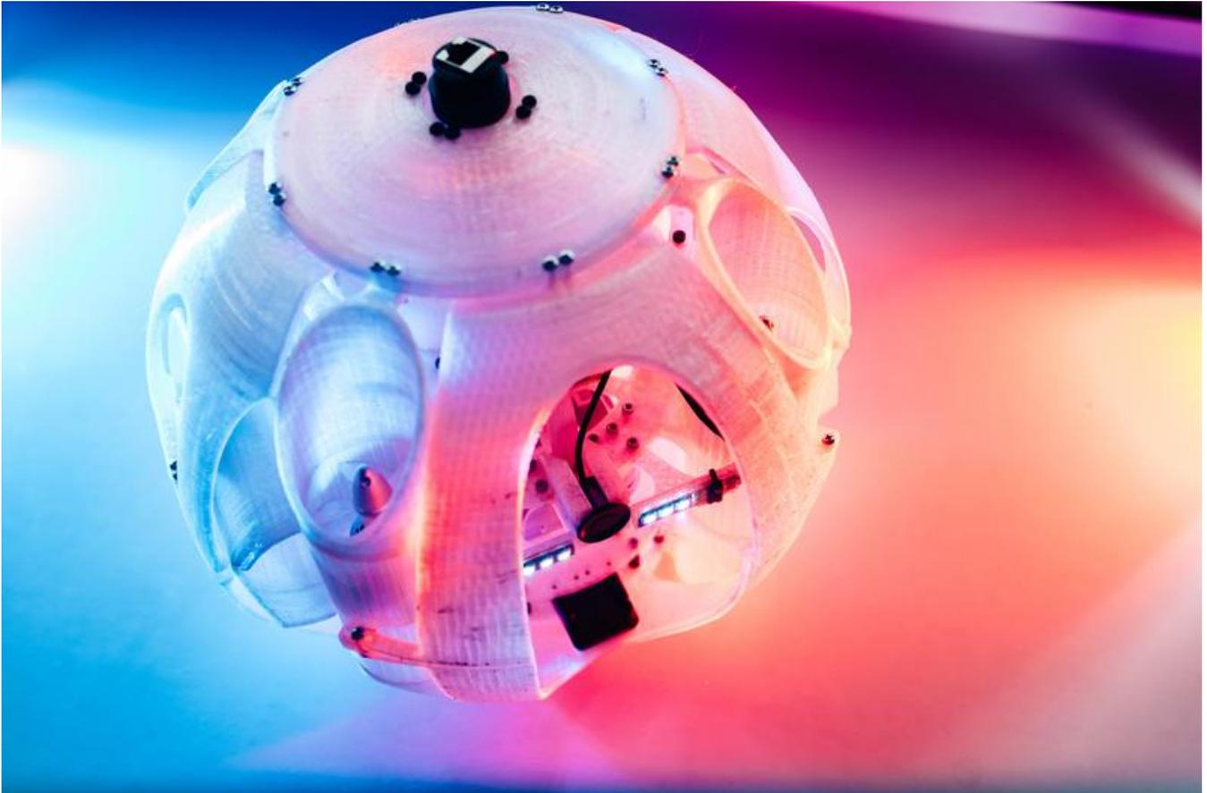
Die Drohne verfügt über ein flexibles Exoskelett.
