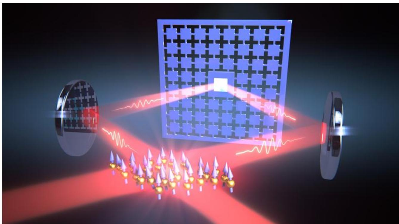
Eine Schleife aus Laserlicht koppelt die Vibrationen einer nanomechanischen Membran an den Spin einer Wolke von Atomen.
