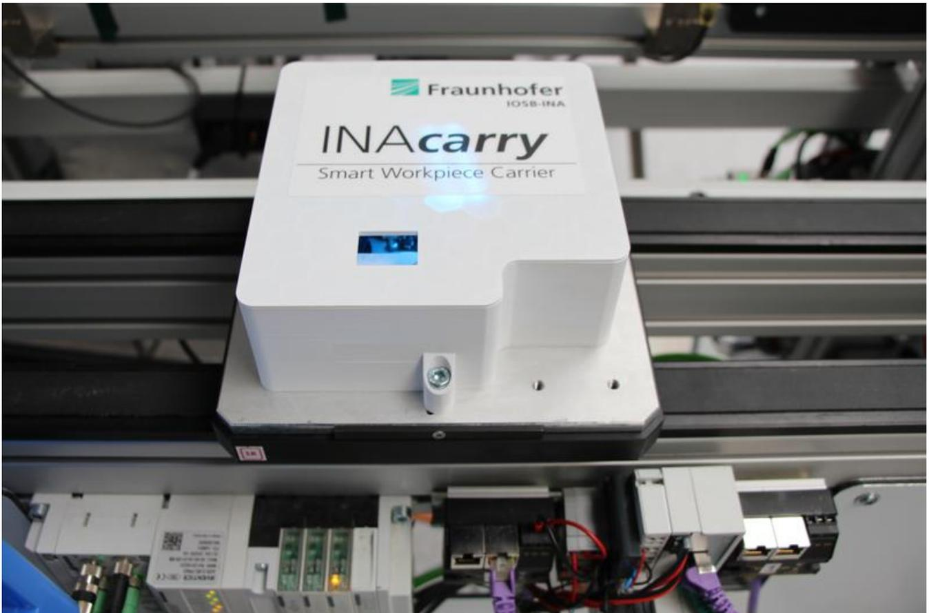
Vereint auf einer Fläche etwa eines Tablets moderne Sensorik: das dezentrale Produktionsdatenerfassungssystem INAcarry von Fraunhofer Lemgo.
