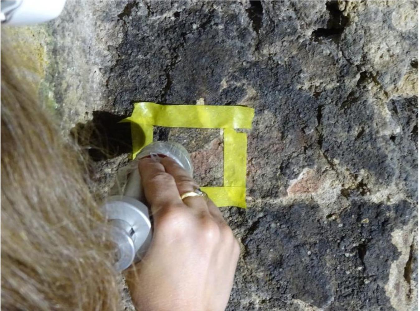
Um die schwarze Gipskruste von Putz- und Sandsteinoberflächen zu entfernen, wurden Laserstrahlen getestet.
