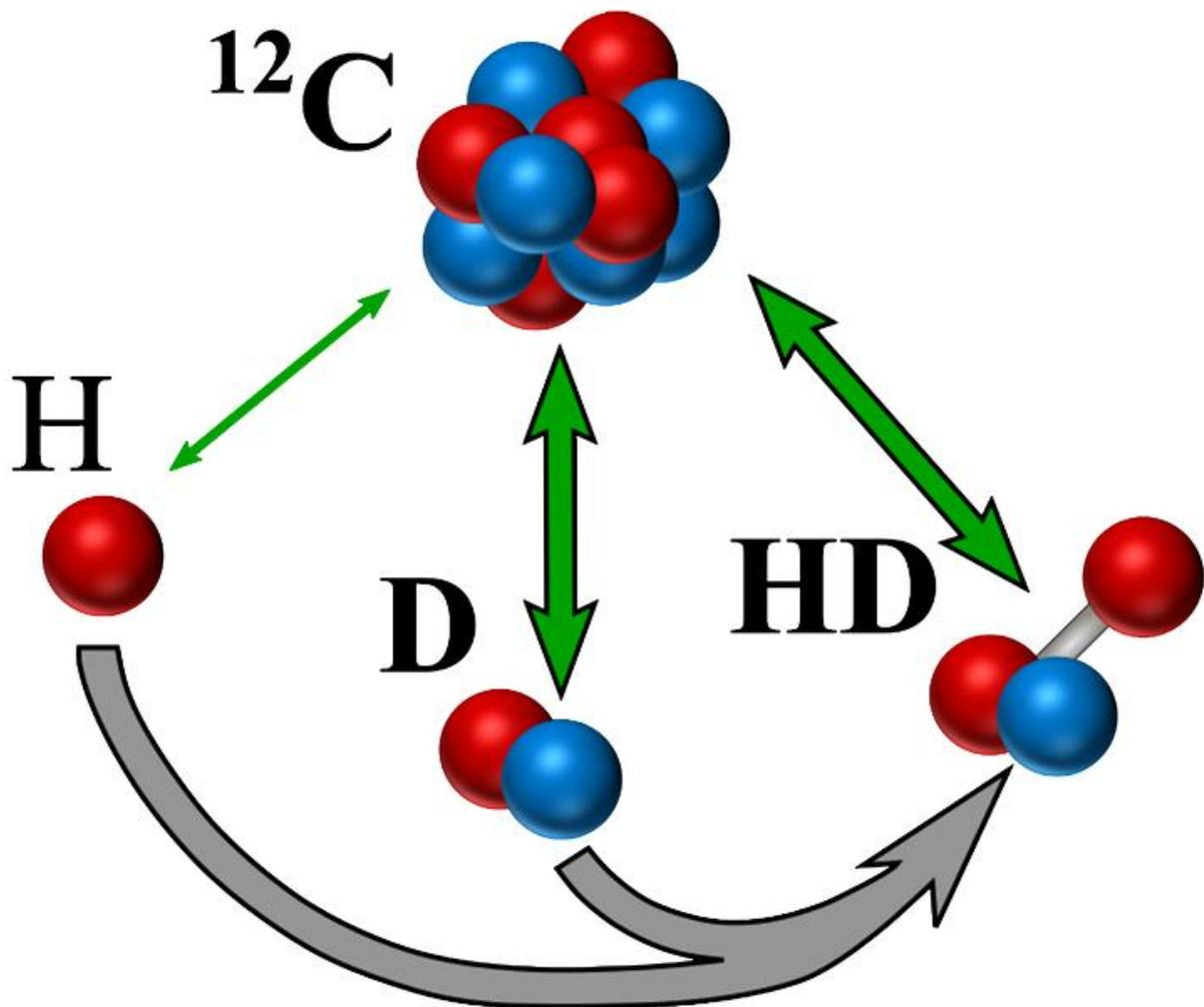
Direkt gegen den atomaren Massenstandard  $^{12}\text{C}$  gemessene Wasserstoffspezies (grüne Pfeile). Die Masse von HD kann auch aus den Massen von H und D und der Bindungsenergie berechnet werden (grauer Pfeil).
