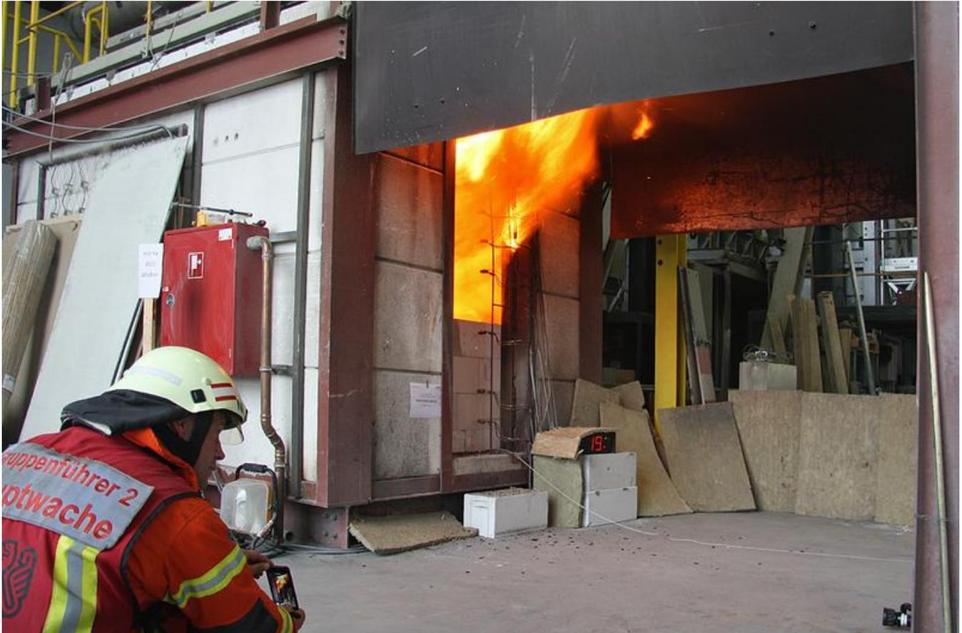
Am Institut für Baustoffe, Massivbau und Brandschutz der TU Braunschweig verschiedene Brandversuche durchgeführt. Hier ist ein Raumbrand-Versuch mit Massivholzbauteilen in Kooperation mit der Feuerwehr Braunschweig zu sehen.
