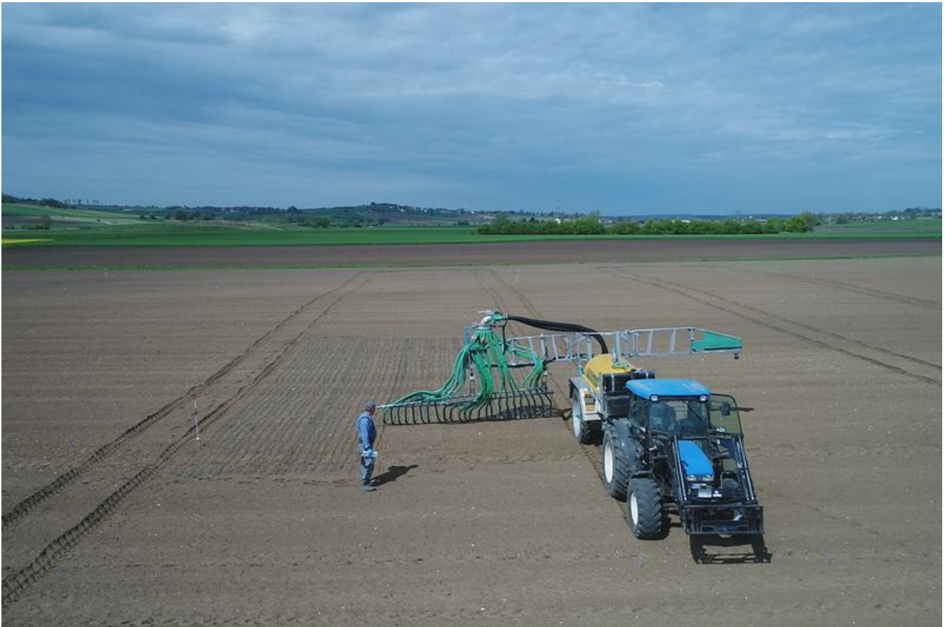
Parzellengenaue Gärrestausbringung mit dem Versuchs-Schleppslauch-Güllefass des TFZ vor der Silomaissaat
