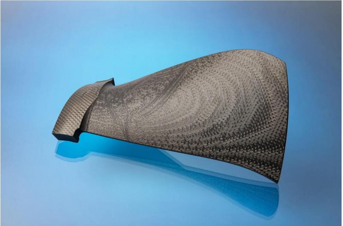
Am Fraunhofer IPT gefertigte FVK-Fan-Schaukel. Das Design ist angelehnt an eine GE90-Fan-Schaukel.
