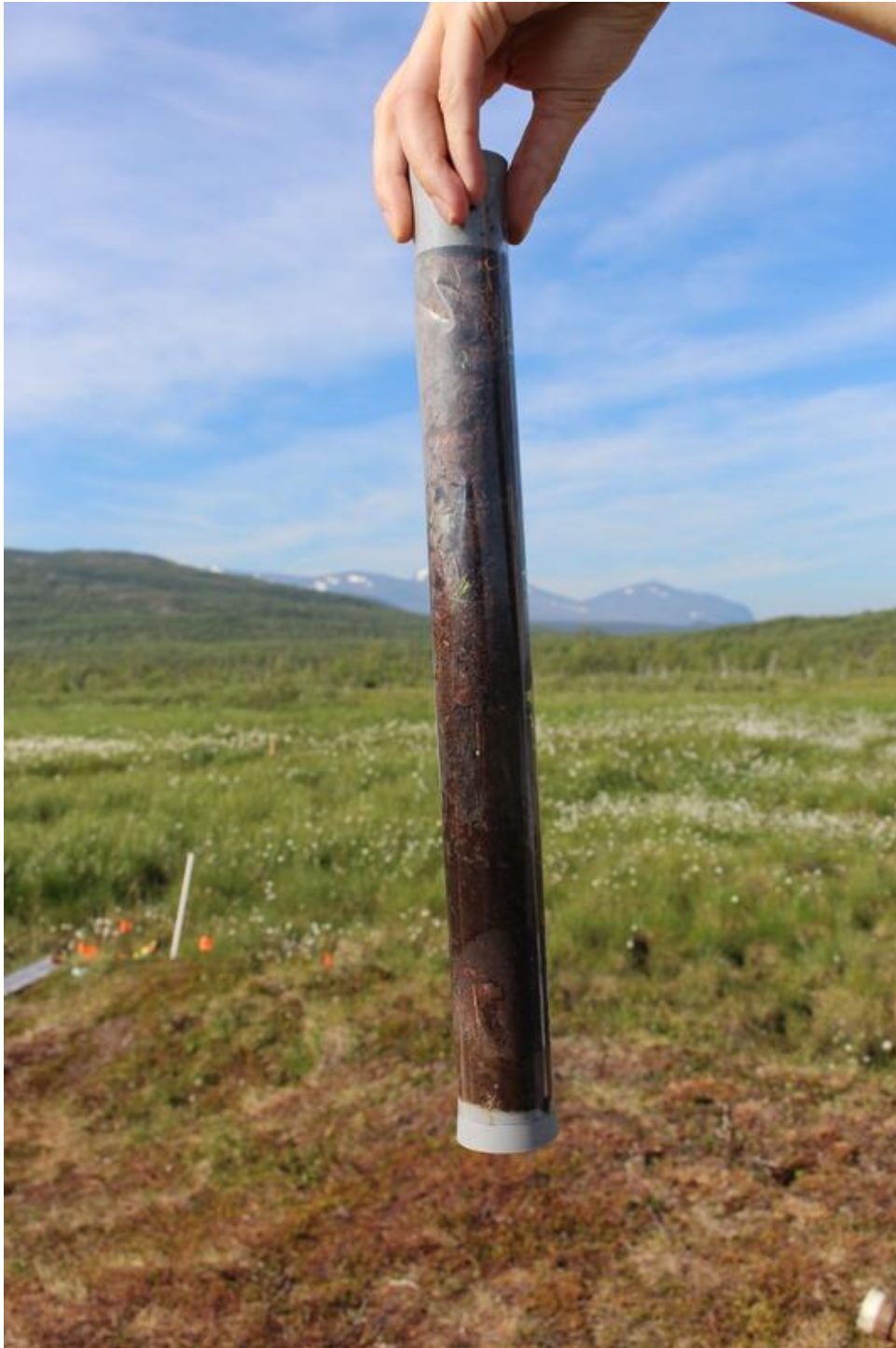
Bohrkern der aktiven Schicht eines Dauerfrostbodens. Foto: Monique Patzner Monique Patzner/Universität Tübingen
