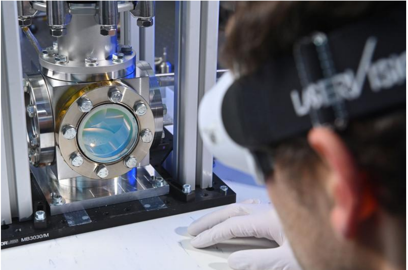
Erste Tests im Vakuum: Der MOONRISE-Laser schmilzt erfolgreich Kugeln aus Mondstaub auf. Foto: LZH
