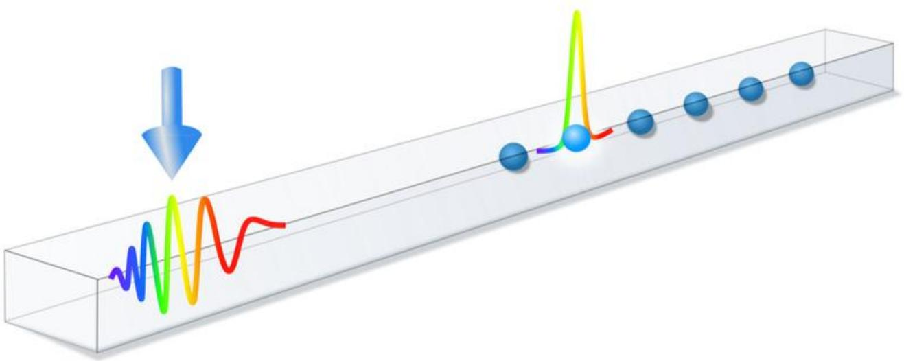
Ein Lichtpuls mit zeitabhängigen Frequenzen kann in einem Wellenleiter einzelne Quantenobjekte ansteuern.
