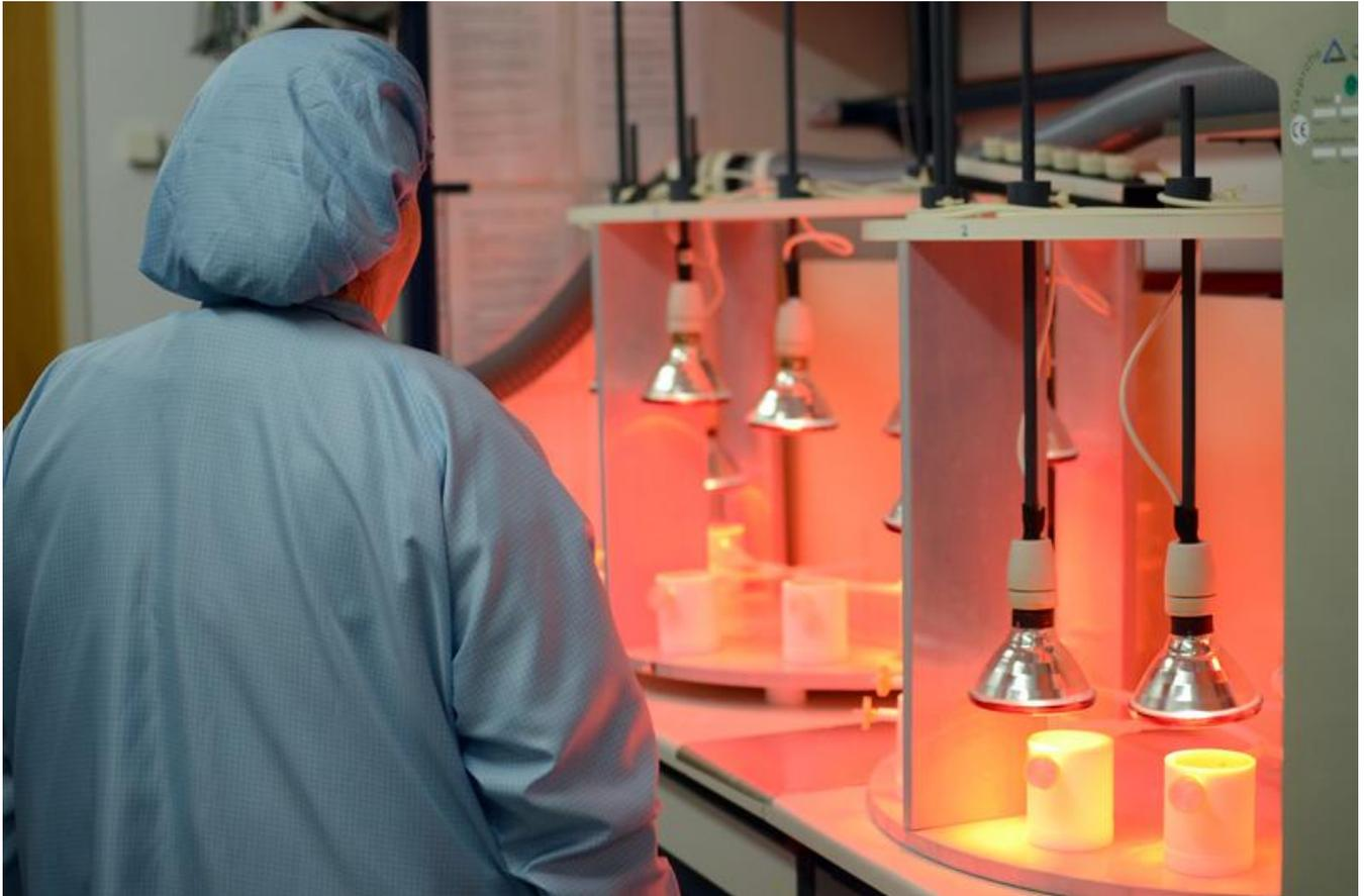
Aufbereitung von Proben für die Isotopen-Untersuchung in den GEOMAR-Laboren.
