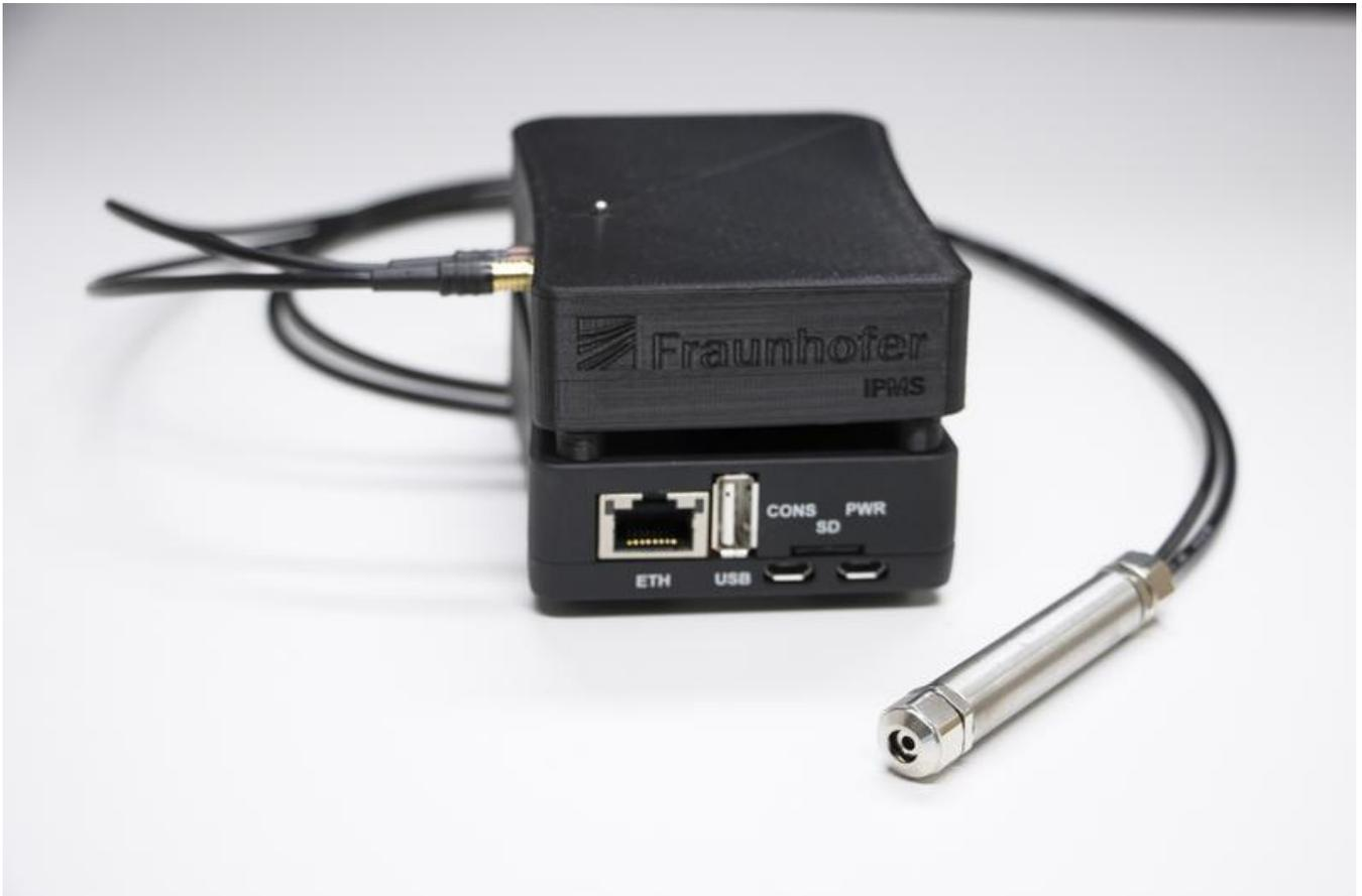
Customer Evaluation Kit für CMUT-Ultraschallsensorik des Fraunhofer IPMS.
