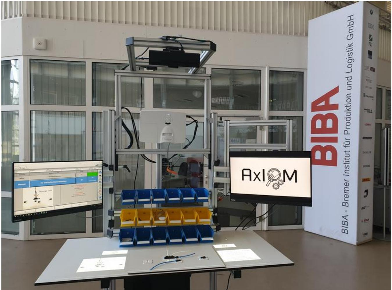
Im F&E-Projekt; „Gamifiziertes KI-Assistenzsystem zur Unterstützung des manuellen Montageprozesses“ (AxIoM) unter Leitung des BIBA ist dieser Prototyp entstanden. Das System ist in Unternehmen aller Größenordnungen und Branchen einsetzbar.
