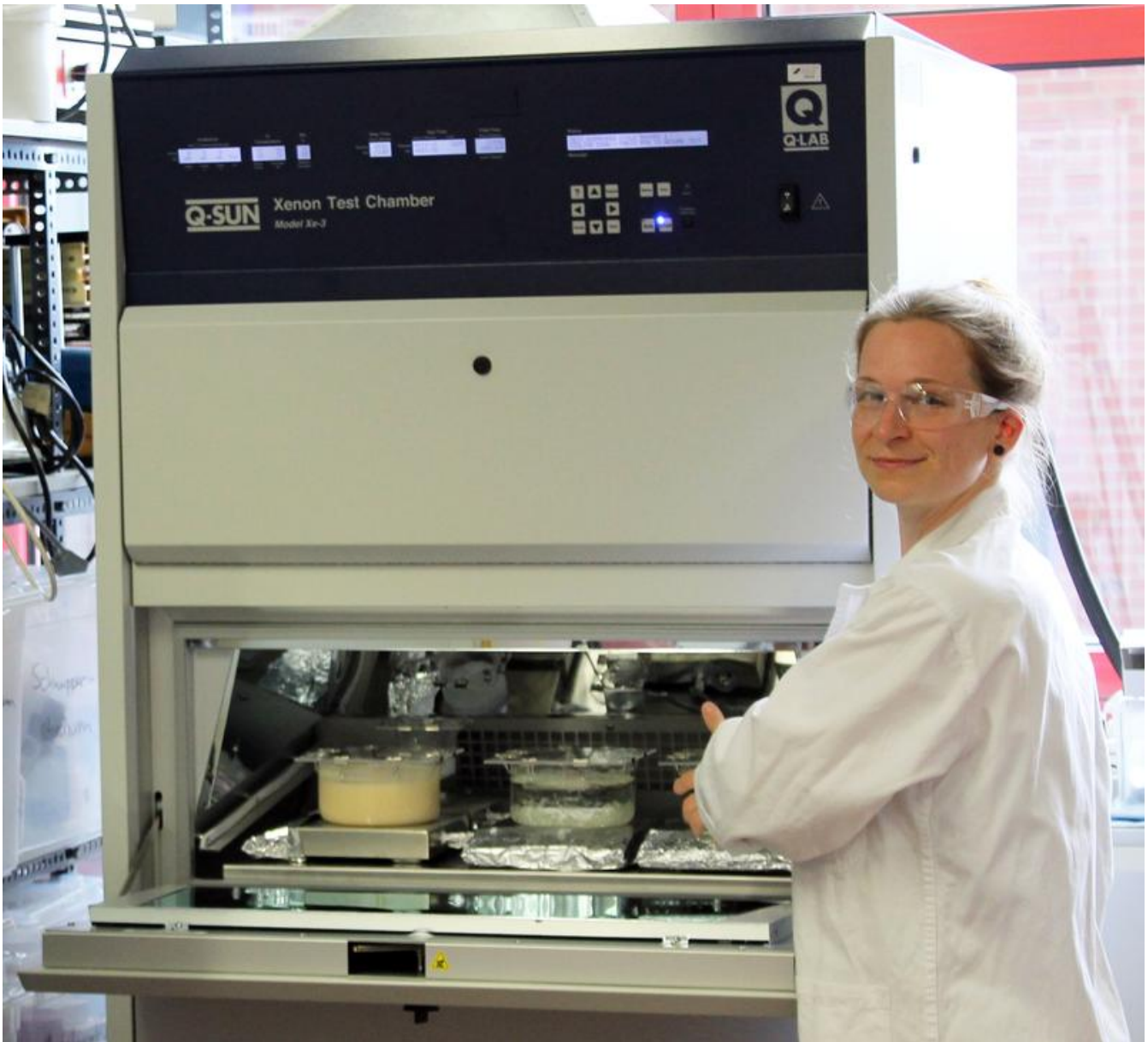
Nora Meides M.Sc., Erstautorin der neuen Studie und Doktorandin in der Makromolekularen Chemie, an einer Bewitterungsanlage. Hier werden Kunststoff-Partikel einer simulierten Sonneneinstrahlung und mechanischen Belastungen ausgesetzt.
