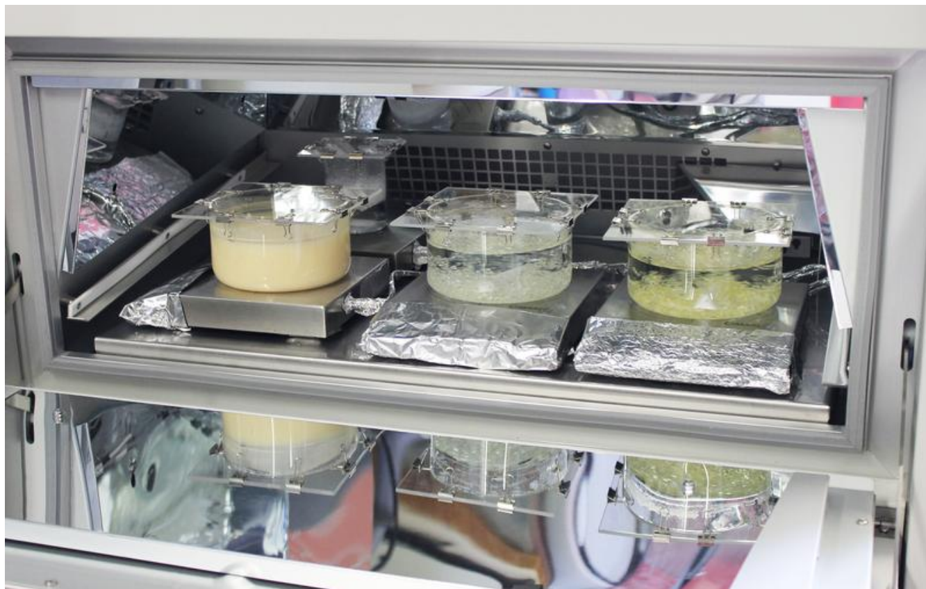
Proben von Kunststoff-Partikeln in der Bewitterungsanlage. Foto: C. Wißler.
