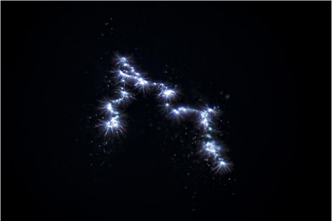
Plasmazündung unter Wasser – mehrere Plasmaentladungen werden durch lange Belichtungszeit eingefangen. Damian Gorczany © Damian Gorczany
