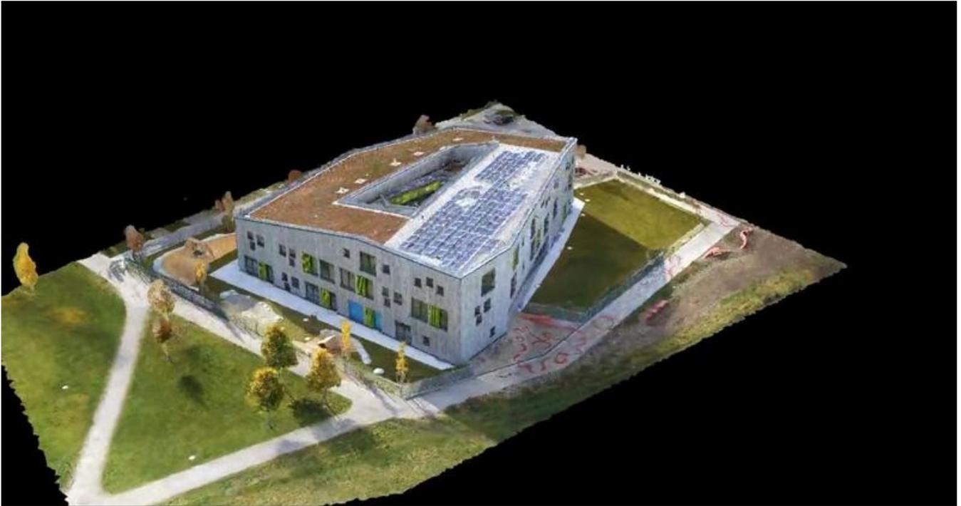
Mit dem berührungslosen Verfahren der sogenannten Photogrammetrie können aus Fotos 3D-Modelle erstellt werden.
