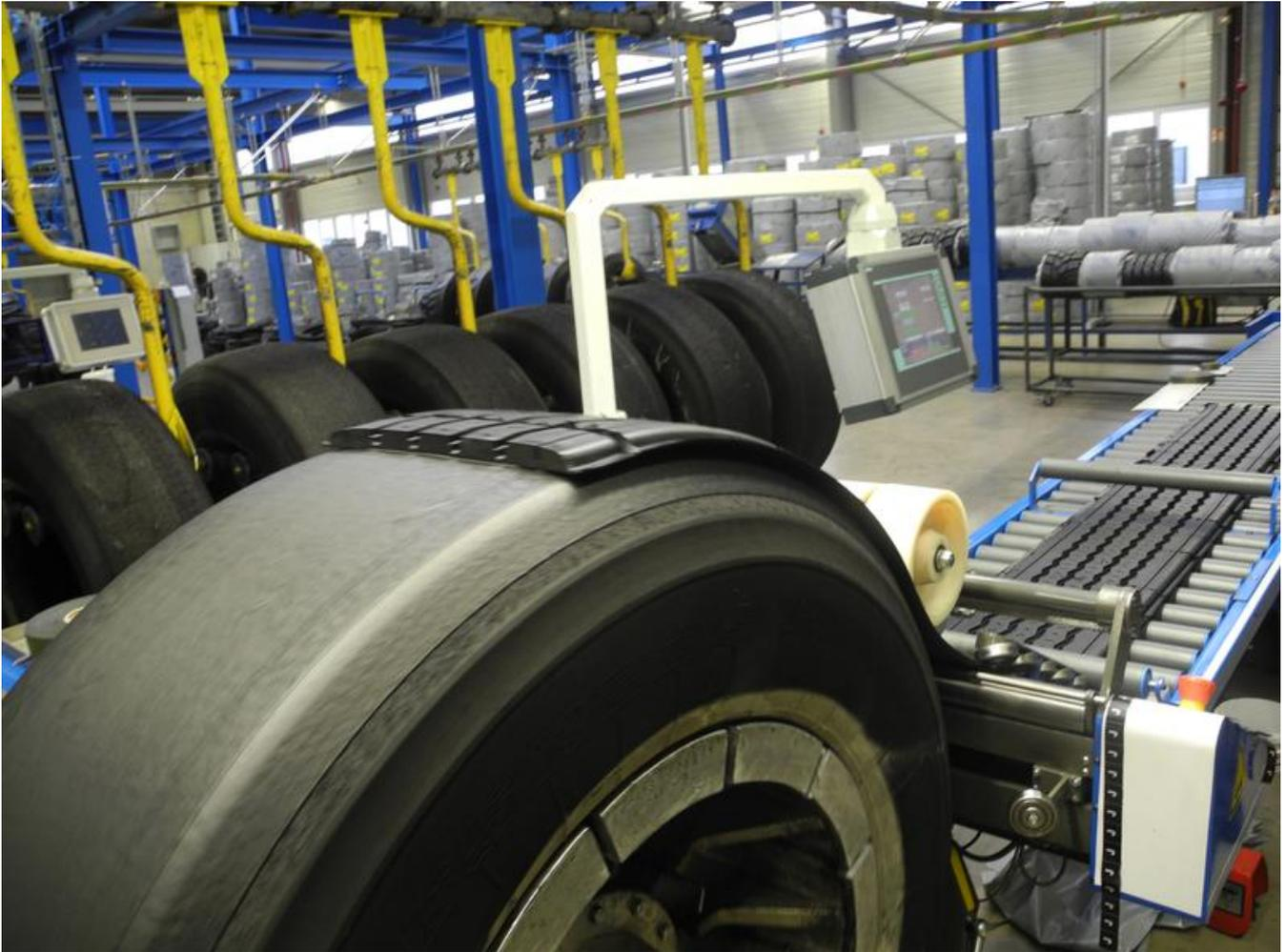
Bei der Runderneuerung wird das Laufflächengummi vom Unterbau abgefahrener Reifen entfernt und eine neue Laufflächenmischung aufgetragen – danach sind sie wieder wie neu.
