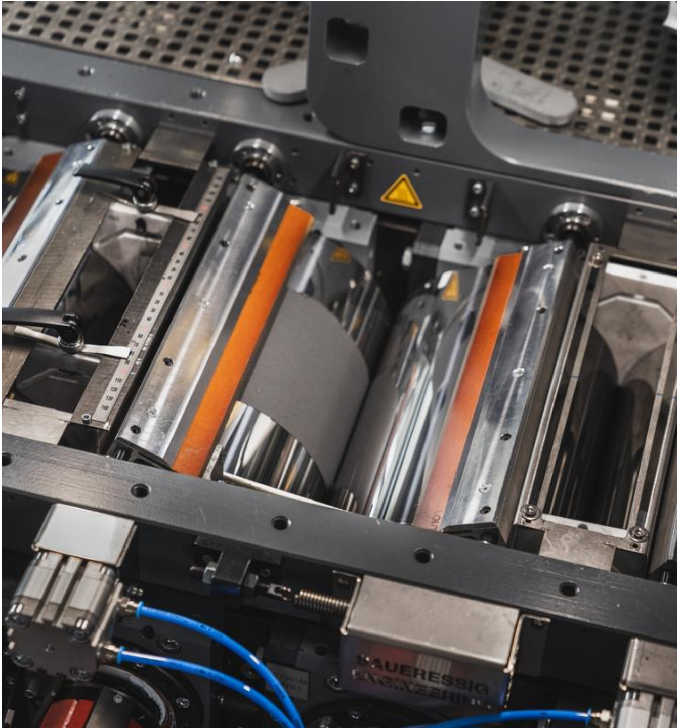
Auf der schneller rotierenden Walze bildet sich ein feiner Beschichtungsfilm. © Fraunhofer IWS Dresden
