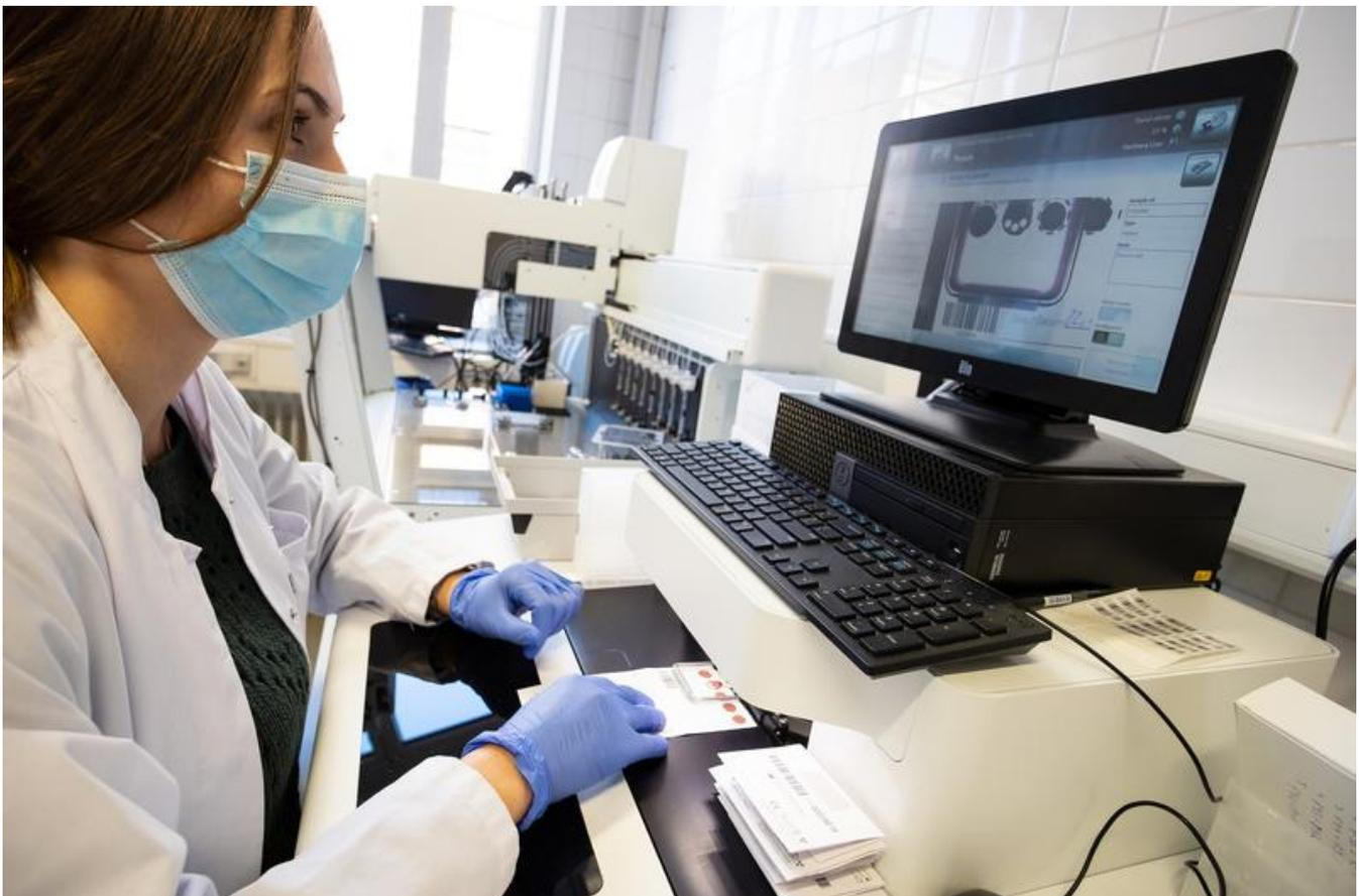
Robotisch assistiertes Ausstanzen von Trockenblutproben (DBS)
