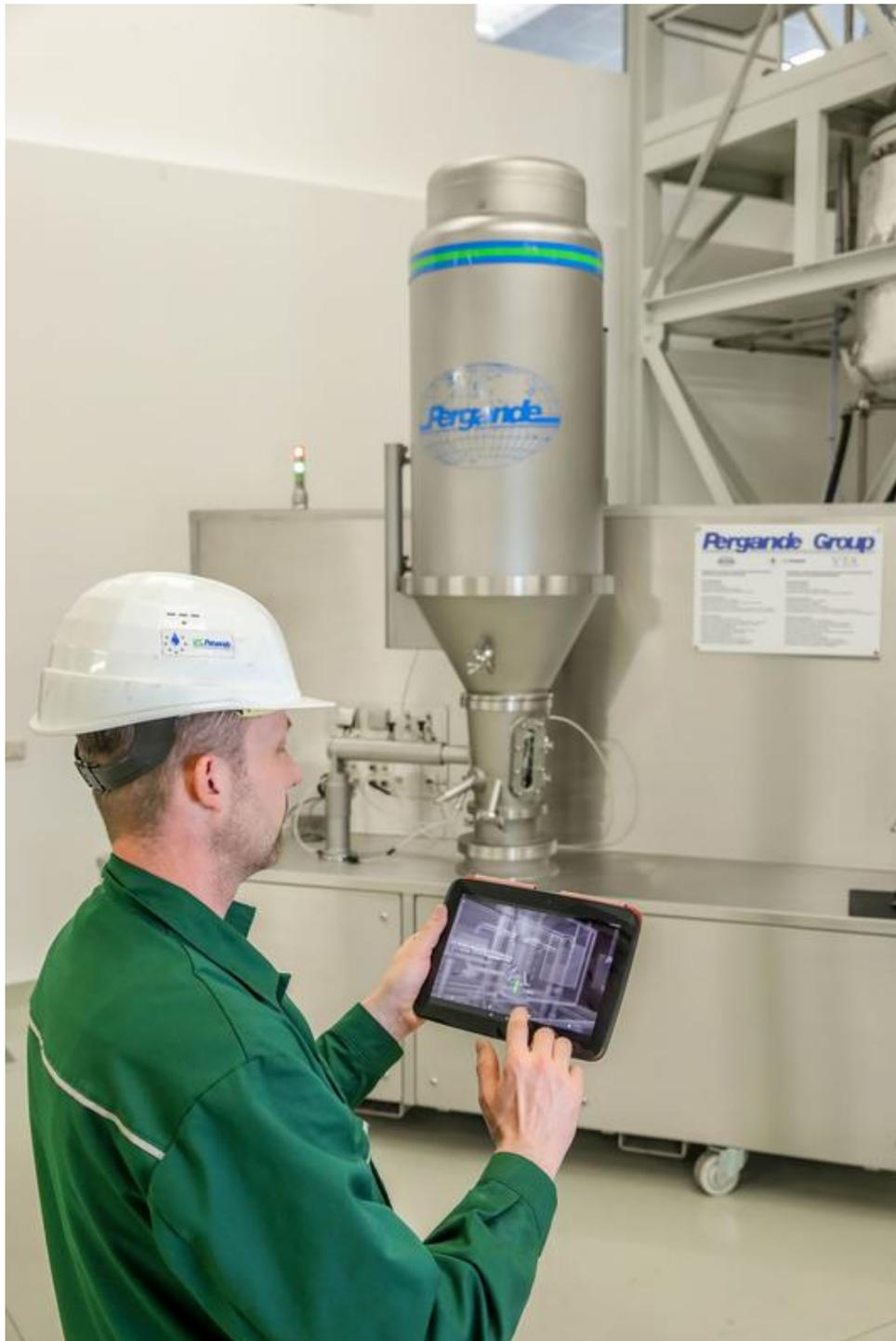
Der intelligente digitale Zwilling des Projekts TwinGuide wird beispielhaft an einer Wirbelschichtanlage für Sprühgranulation beim Anwendungspartner Pergande Group erprobt.
