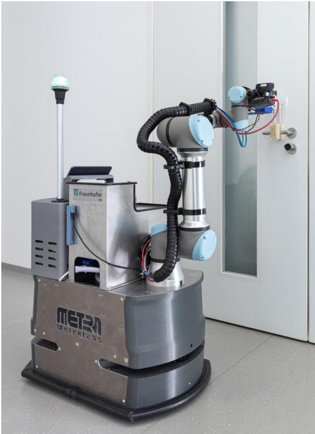
Mit seinen Reinigungsbürsten entfernt DeKonBot 2 groben Schmutz an der Türklinke und trägt gleichzeitig flächendeckend Desinfektionsmittel auf.
