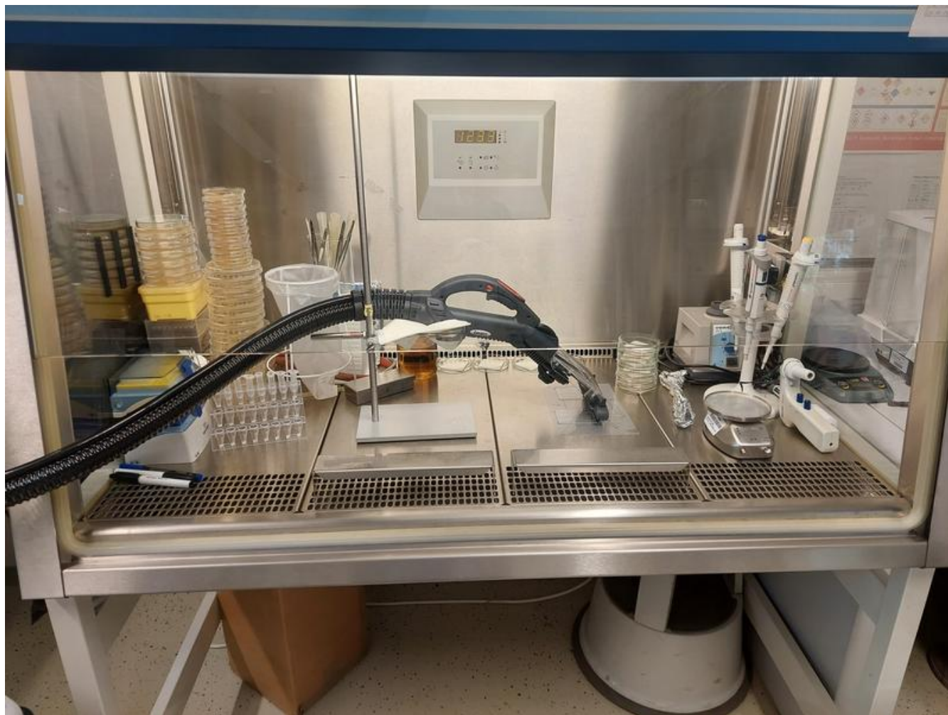
Versuchsaufbau mit Dampfsauger zur Analyse des Reinigungserfolgs © Fraunhofer FEP; Bildquelle in Druckqualität: www.fep.fraunhofer.de/presse
