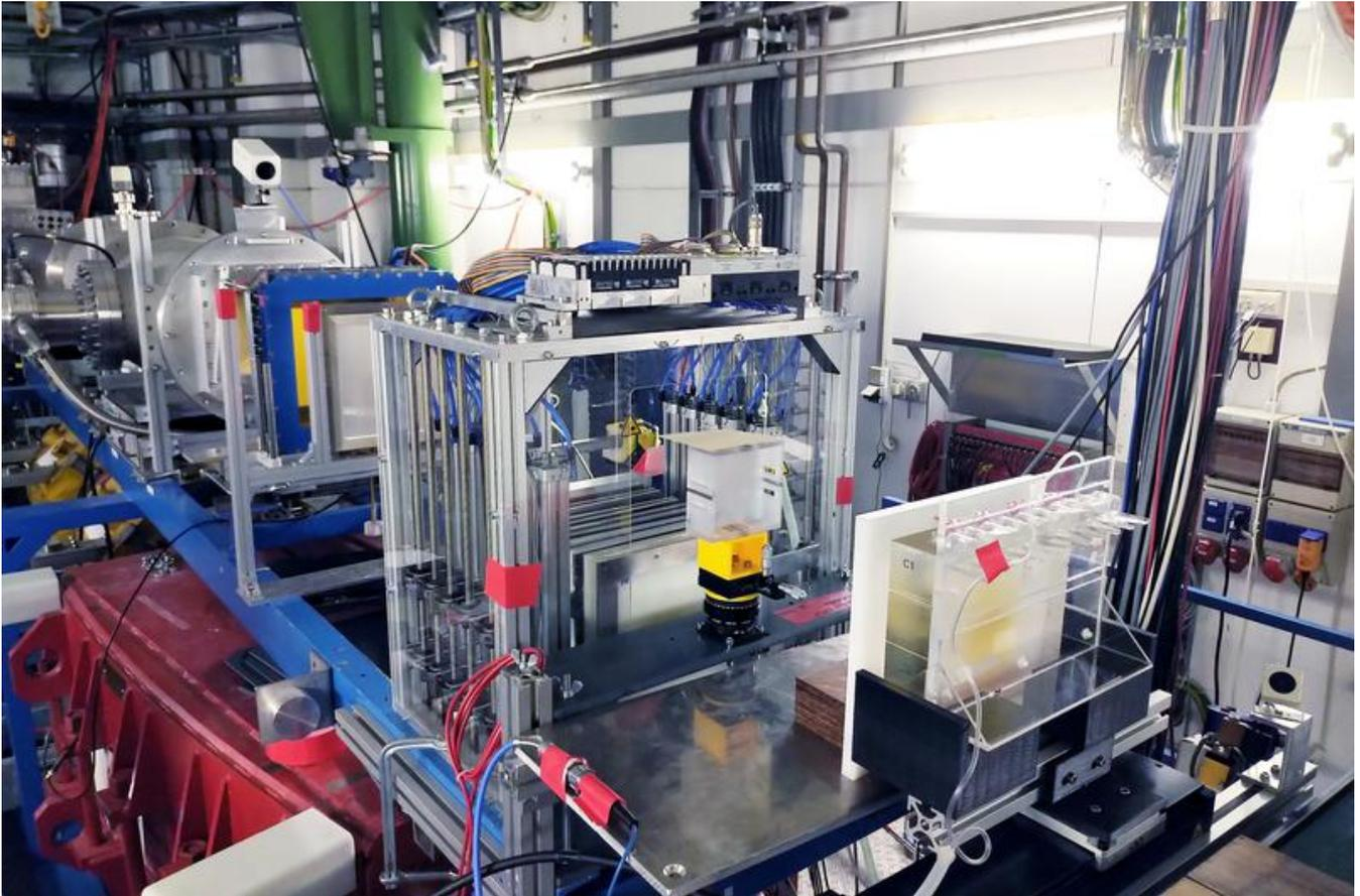
Aufbau für ein FLASH-Experiment bei GSI/FAIR: Hierbei wird eine hohe Strahlendosis in sehr kurzer Zeit von etwa 100 Millisekunden appliziert.
