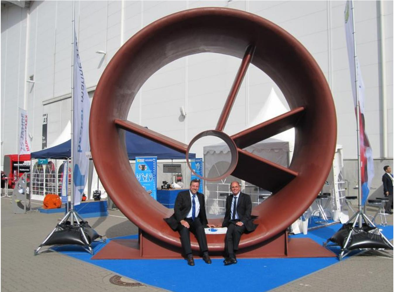
Der Becker Mewis Duct mit Dirk Lehmann (links) Friedrich Mewis. Die beiden Ingenieure haben mit dieser Schiffspropeller-Vordüse für die Einsparung von rund zwölf Millionen Tonnen klimaschädlichem Kohlendioxid gesorgt.
