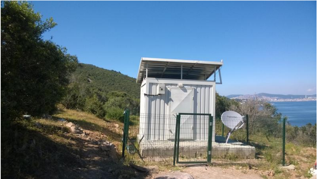
Erdbebenmessstation in der Nähe von Istanbul. Sie gehört zum Geophysikalischen Observatorium an der Anatolischen Störung (GONAF). GFZ GFZ
