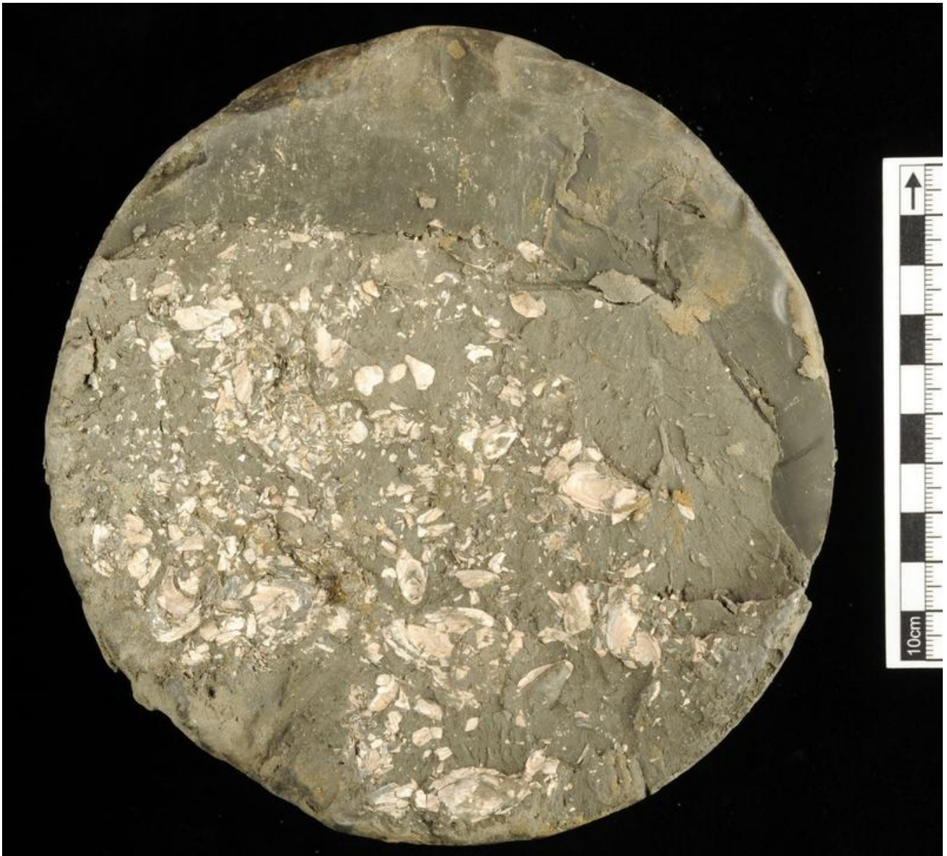
Querschnitt eines Bohrkerns mit Schalen fossiler Wandermuscheln © NHM Wien © NHM Wien
