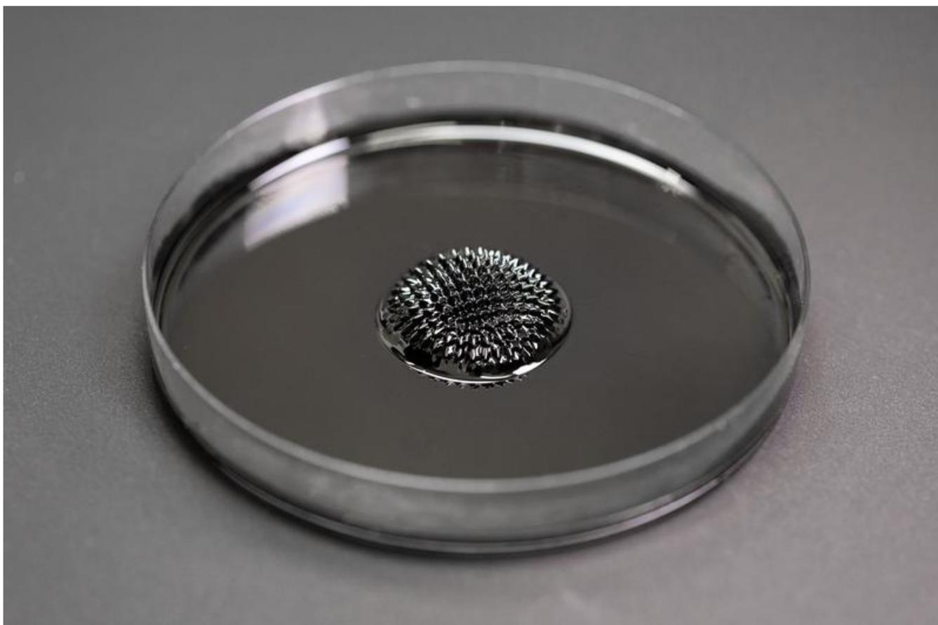
Ein charakteristischer Effekt von Ferrofluiden: der Rosensweigeffekt. Dabei sorgen starke Magnetfelder für die Ausbildung von flüssigen Stacheln, welche Magnetfeldlinien folgen.
