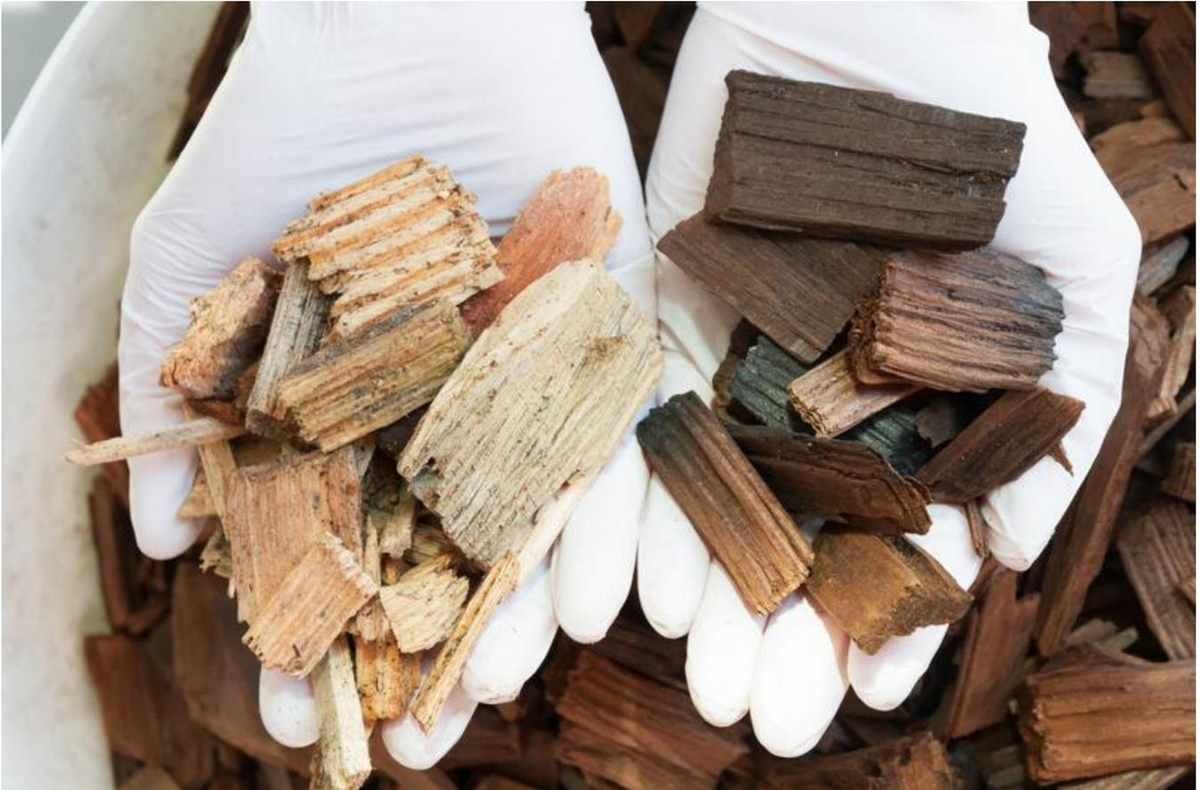
Mittels überhitztem Wasserdampf torrefizierte Buchenholz-Hackschnitzel (rechts) haben im Vergleich zu unbehandelten Hackschnitzeln (links) einen erhöhten Brennwert und sind zudem wasserabweisend.
