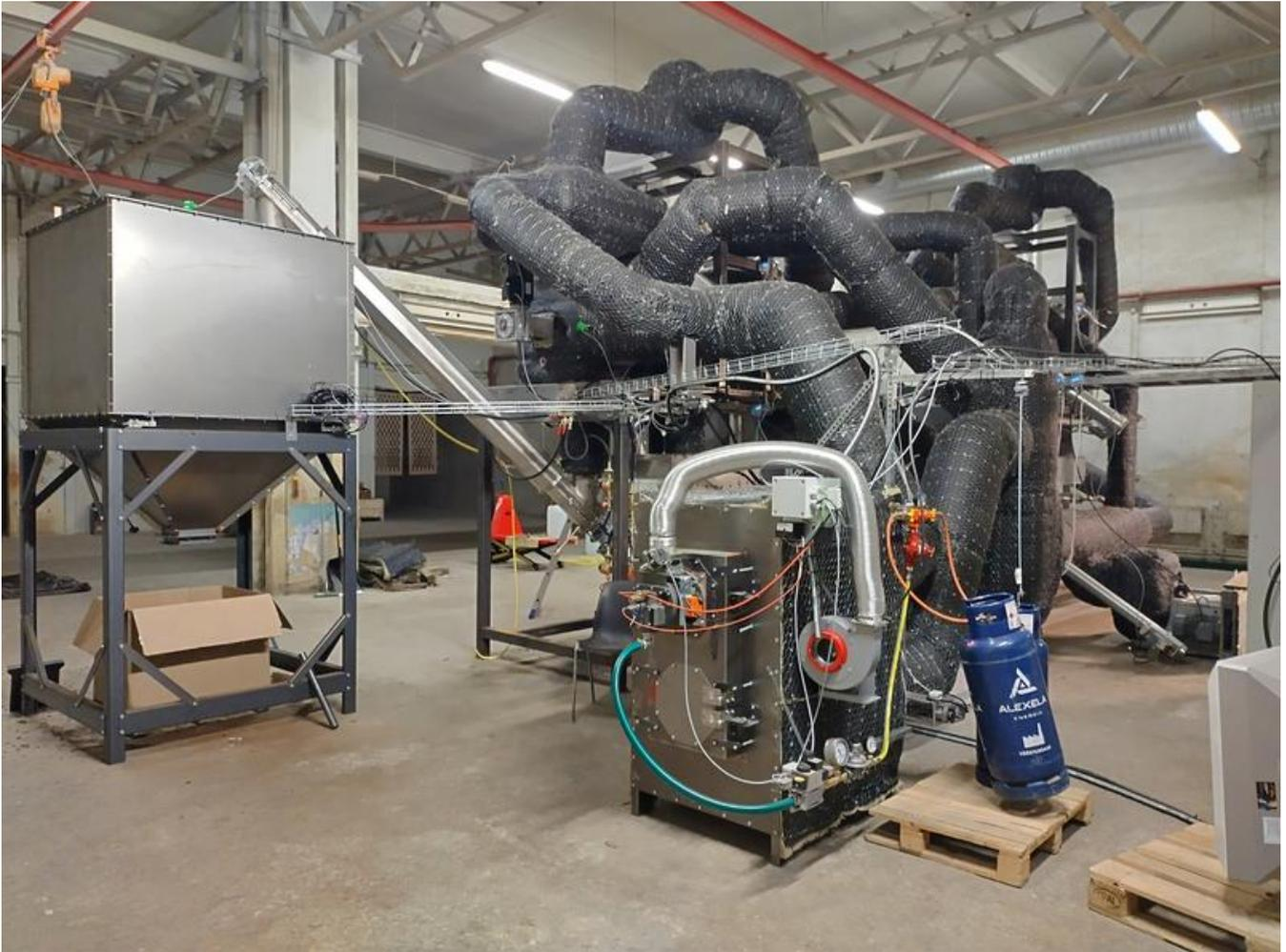
Erster großtechnischer Prototyp Uniformer® zur Torrefizierung von Biomasse mit überhitztem Wasserdampf
