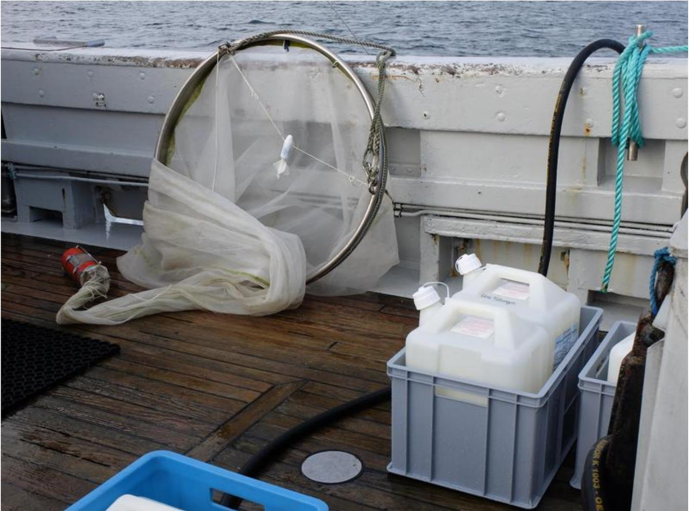
Beprobung auf dem Schiff, um Meerwasser aus der Nordsee zu erforschen. Das Meerwasser wird in große Kanister gefüllt und gekühlt zurück ins Labor gebracht, wo die Mikrokosmenexperimente durchgeführt werden
