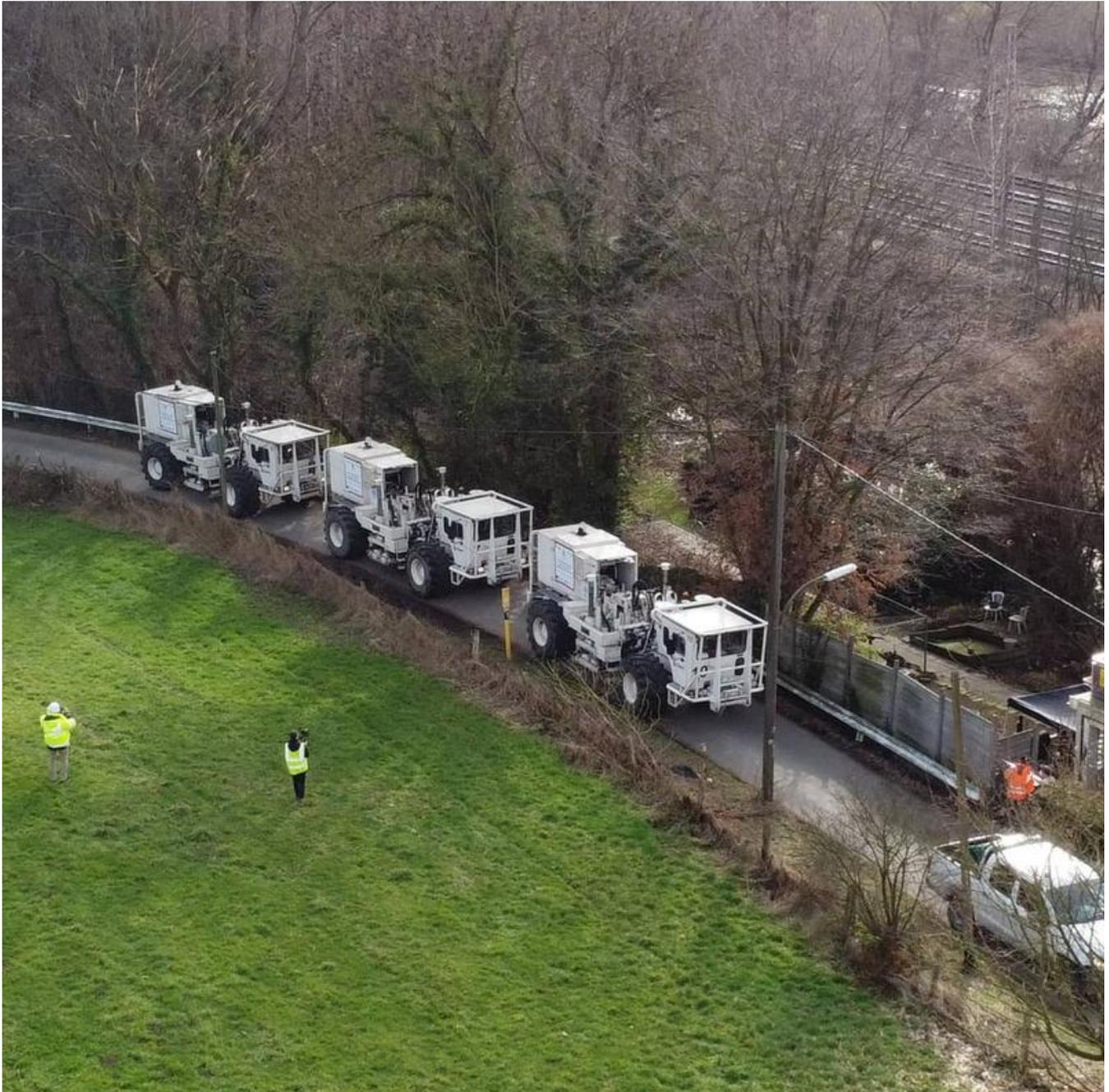
Geophysikalische Exploration: Nach dem Prinzip des Echolots durchschallen Messwagen den Untergrund in mehreren Kilometer Tiefe und suchen geeignete Gesteine für die Tiefe Geothermie.
