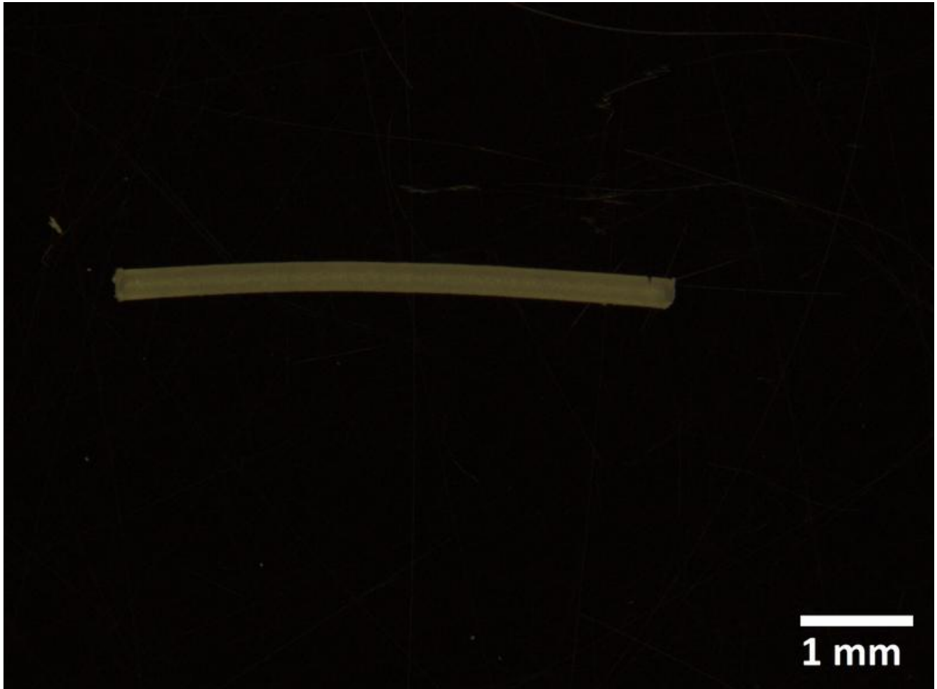
Ein Stärkeimplantant in mikroskopischer Aufnahme Uni Halle / Esfahani Golbarg
