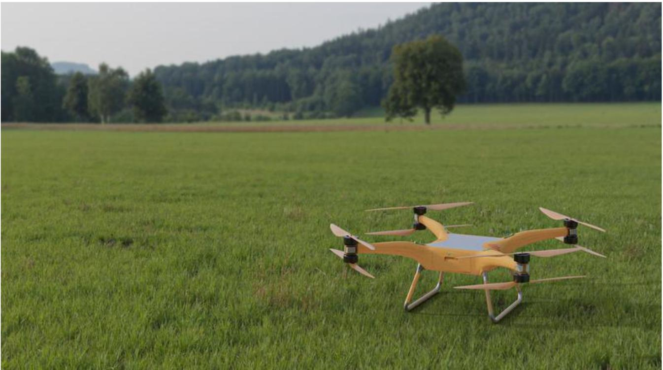
Dank effizienter, biobasierter Strukturdesigns sowie modularer Bauweise sind die neuen Fluggeräte deutlich nachhaltiger als konventionelle Multicopter.
