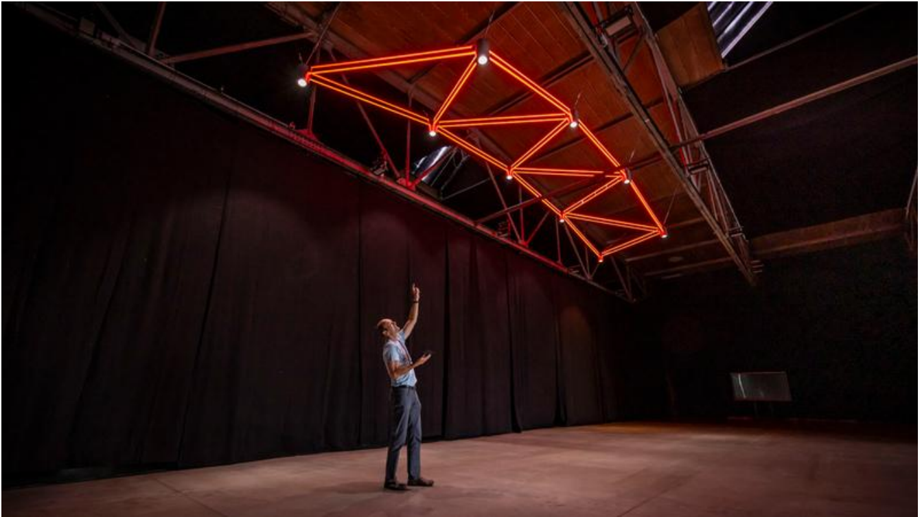
Projektleiter Roy Lange vom Forschungsbereich "Leichtbau im Bauwesen" der TU Chemnitz testet bei der Inbetriebnahme in der Eventhalle der KRAFTVERKEHR Event GmbH in Chemnitz das neue Beleuchtungsgitter. Foto: Jacob Müller
