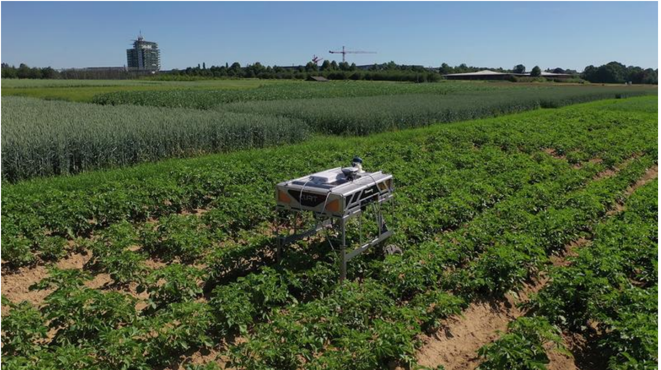
Der große Roboter CURTdiff kann Pflanzreihen autonom erkennen und abfahren und so perspektivisch z. B. für die Beikrautregulierung eingesetzt werden. Fraunhofer IPA
