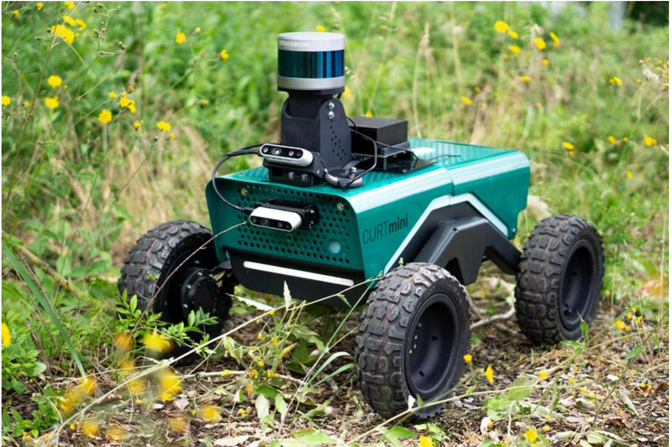
Der kleine mobile Roboter CURTmini erkennt autonom Untergründe, schätzt diese nach ihrer Befahrbarkeit ein und plant den Pfad entsprechend. Fraunhofer IPA
