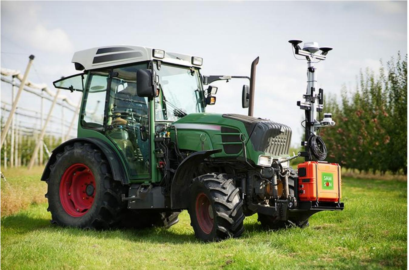
Über die Dreipunktaufnahme an jedem Schlepper montierbar: die im Rahmen des Projekts »SAMSON« vom Fraunhofer IFAM in Stade entwickelte »Sensorbox« zur Datenaufnahme und -verarbeitung in Obstbauanlagen.
