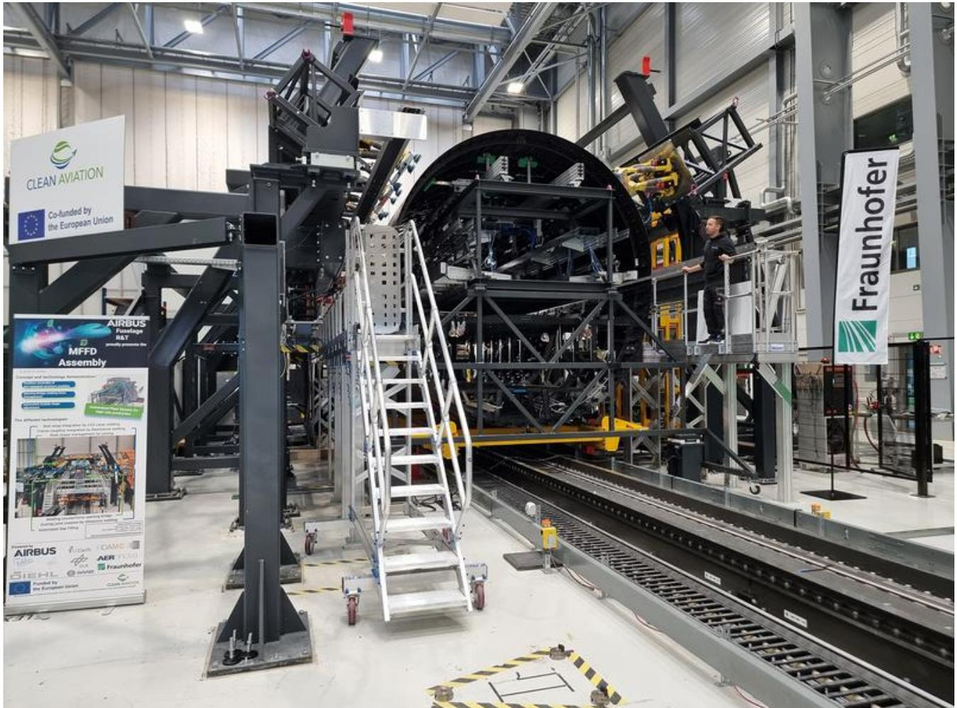
Die »MFFD«-Montage-Forschungsplattform mit eingerüsteten thermoplastischen Rumpfschalen bei der Fraunhofer-Gesellschaft in Stade
