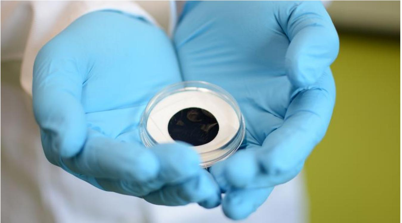
Vertikal ausgerichtete Kohlenstoff-Nanoröhrchen sind eine ideale Membran, um das Wechselspiel der Kräfte innerhalb von Nanoporen zu untersuchen.
