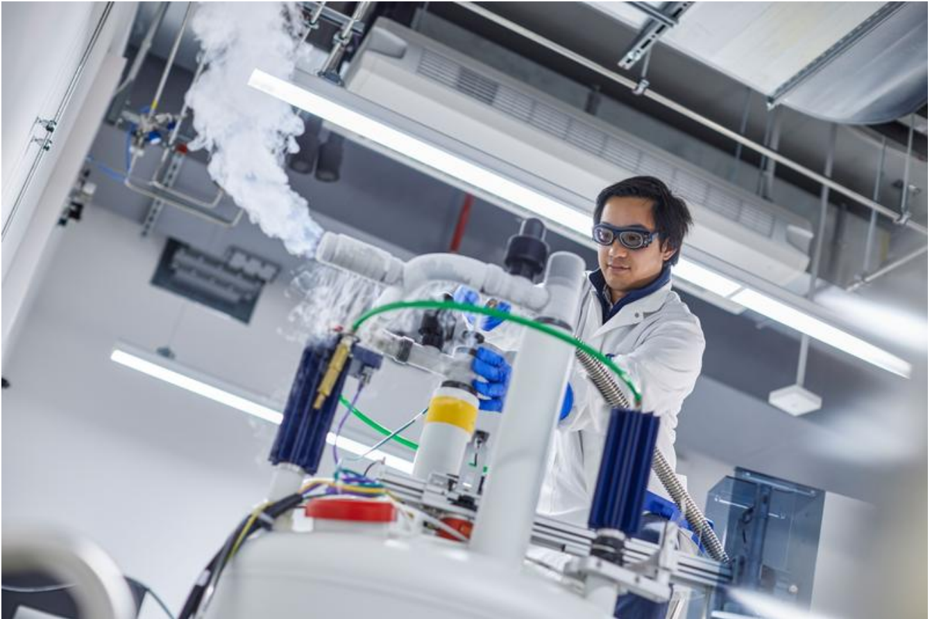
Das Gerätezentrum bietet verschiedenste NMR-Techniken an. Hier im Bild zu sehen ist ein 400 MHz Hochfeldspektrometer mit kryogen gekühltem Probenkopf. Hans-Georg Merkel RPTU, Hans-Georg Merkel
