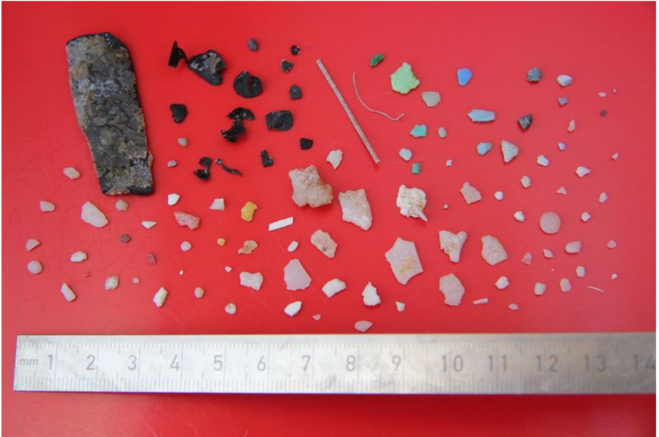
Auswahl an Plastikpartikeln aus dem Neustonnetz, die ausgeprägte Verwitterung und eine große Vielfalt an Größen, Formen und Farben aufweisen.
