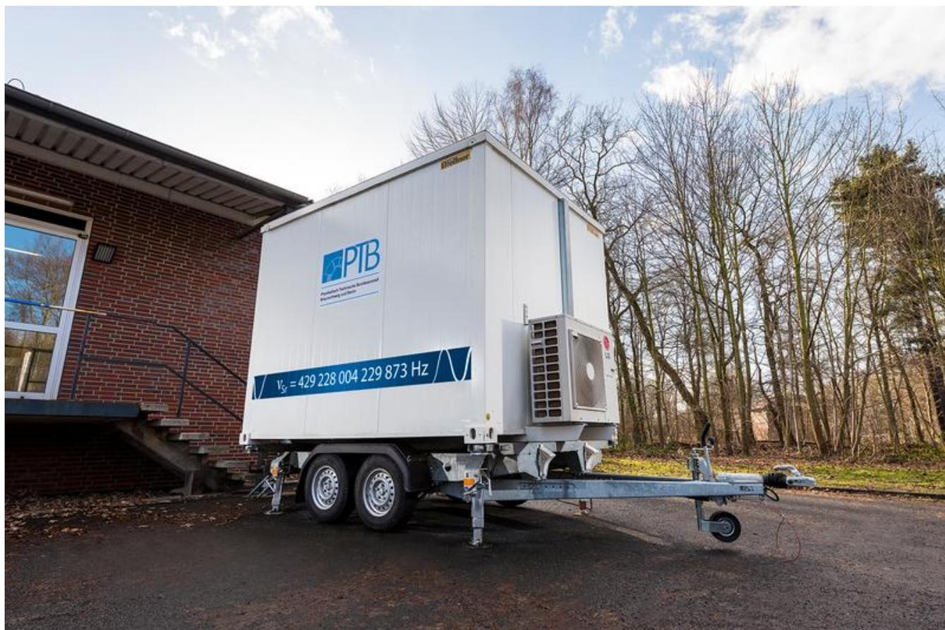
Die transportable optische Uhr ist in einem Anhänger untergebracht.
