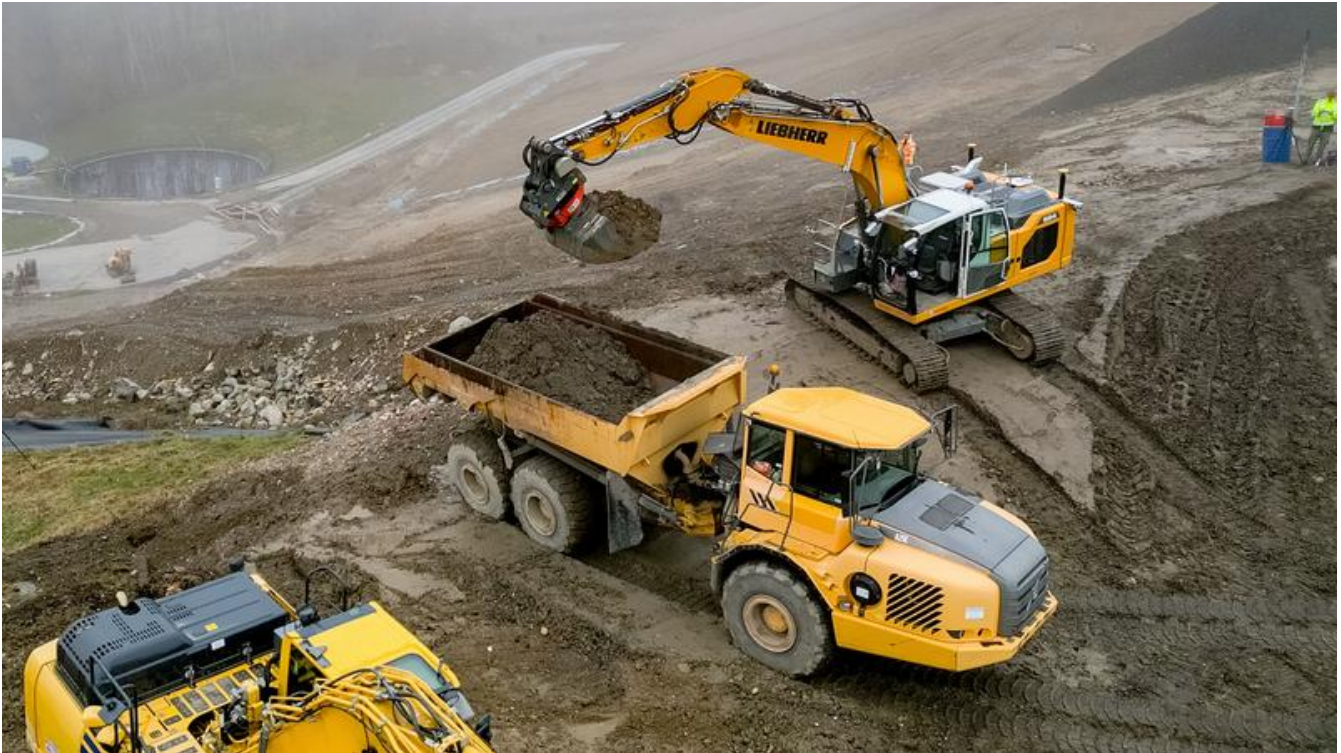
Der autonome 24-Tonnen-Bagger ALICE belädt autonom einen Muldenkipper im Kontext der Sanierung einer Deponie. Fraunhofer IOSB
