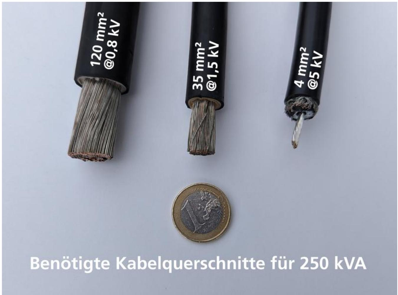
Bei einem PV-Stringwechselrichter mit 250 kVA wird bei einer Erhöhung der Ausgangsspannung von 800 VAC auf 1.500 VAC der Kabelquerschnitt um 75 Prozent reduziert.
