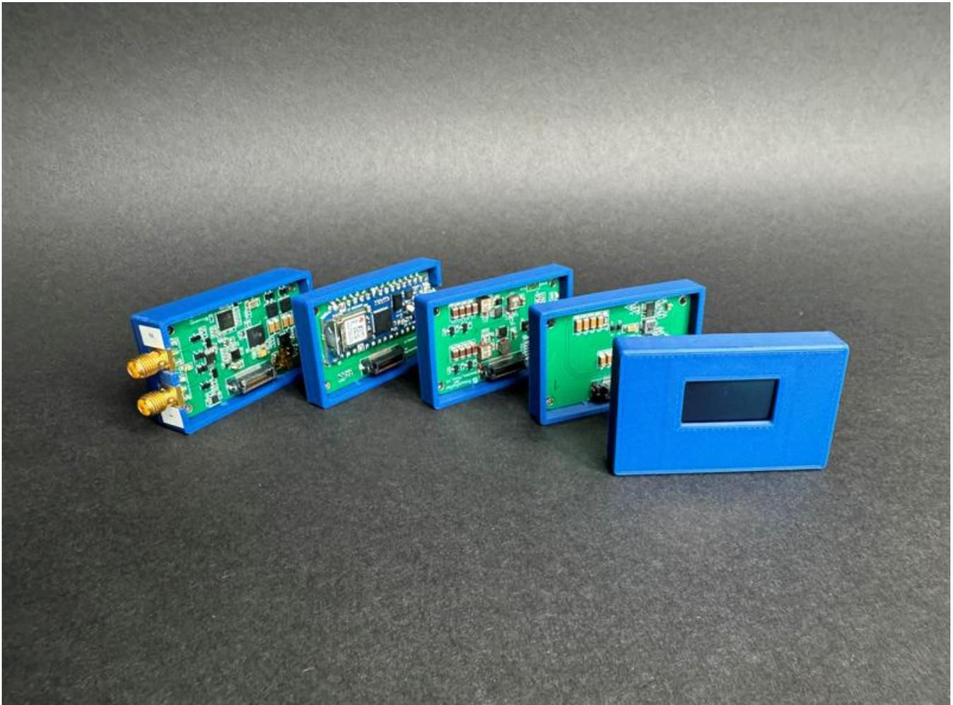
Einzelmodule des Ultraschallsystems »SonoOne«.
