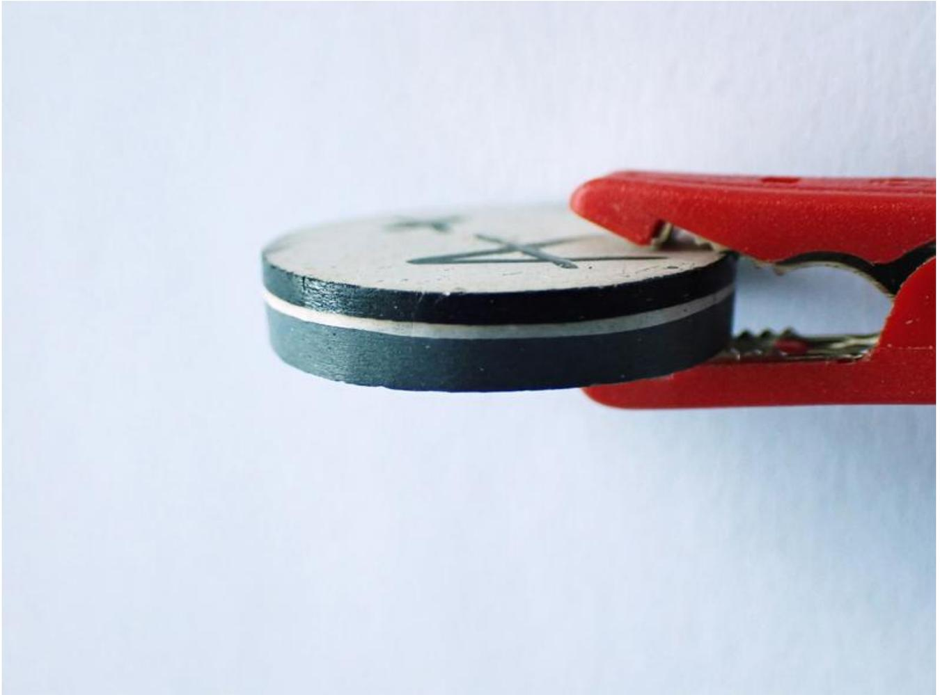
Im FAST/SPS-Sinterverfahren hergestellte Festkörperbatterie
