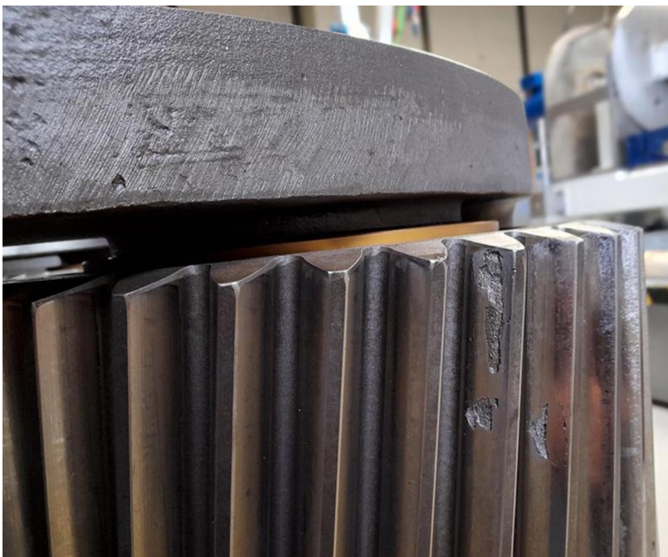
Grübchenschaden an einem Getriebe für Windenergieanlagen. Institut für Maschinenelemente (IMA), Universität Stuttgart
