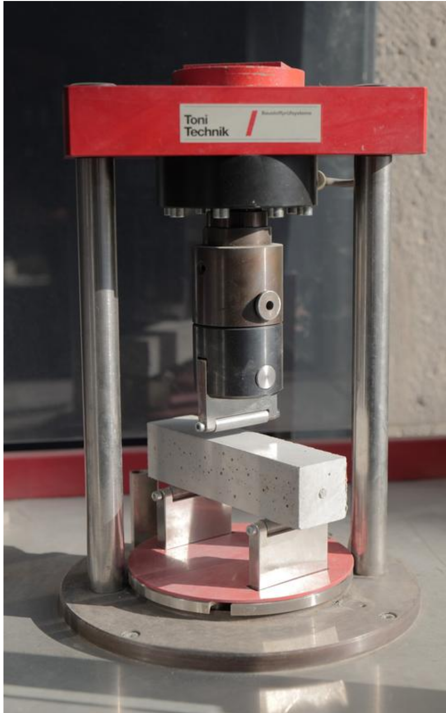
In baustofftechnologischen Untersuchungen wurde die Festigkeit der Mischungen getestet. Benedict Bremert TH Köln
