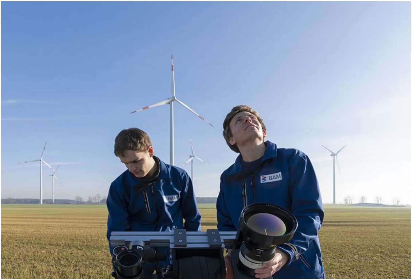
Inspektion von Windenergieanlagen mit Thermografie und KI BAM
